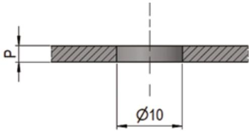
Per spessori  $P$  fino a 2 mm è possibile l'installazione senza utilizzare la rondella di tenuta eseguendo un foro di  $\text{Ø} 8,2$  mm
